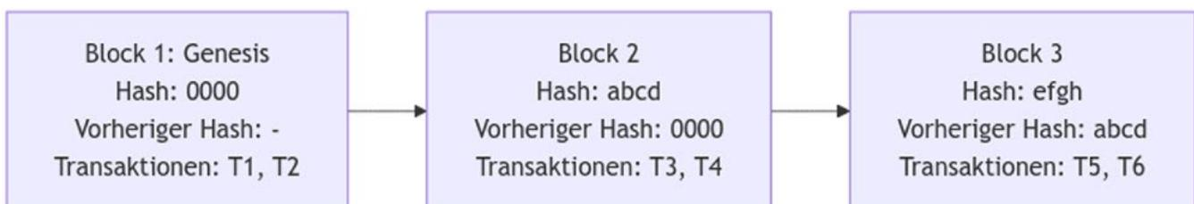
Bild 1: Schematische Darstellung der Speicherung von Daten in einer Blockchain. Quelle: Oliver Bodemer
