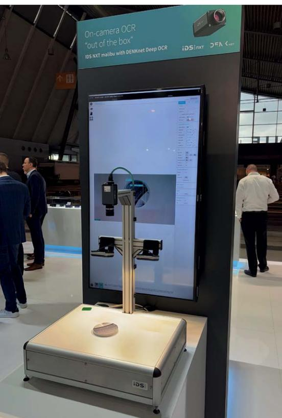
Als Demo auf der Messe Vision 2024 zu sehen: Optische Zeichenerkennung mittels einer intelligenten Kamera der Serie »IDS NXT malibu« und DENKnet-Deep-OCR. (Bild: IDS Imaging Development Systems)
