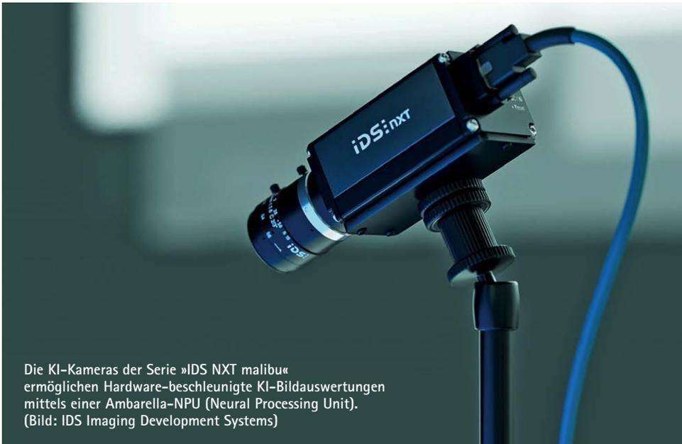
Die KI-Kameras der Serie »IDS NXT malibu« ermöglichen Hardware-beschleunigte KI-Bildauswertungen mittels einer Ambarella-NPU (Neural Processing Unit). (Bild: IDS Imaging Development Systems)
