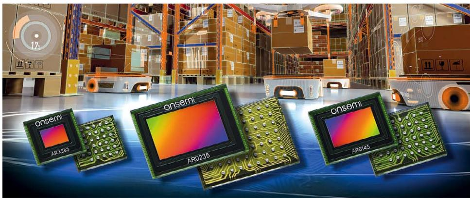
Bild 3: Bildsensoren der Serie Hyperlux SG von onsemi
