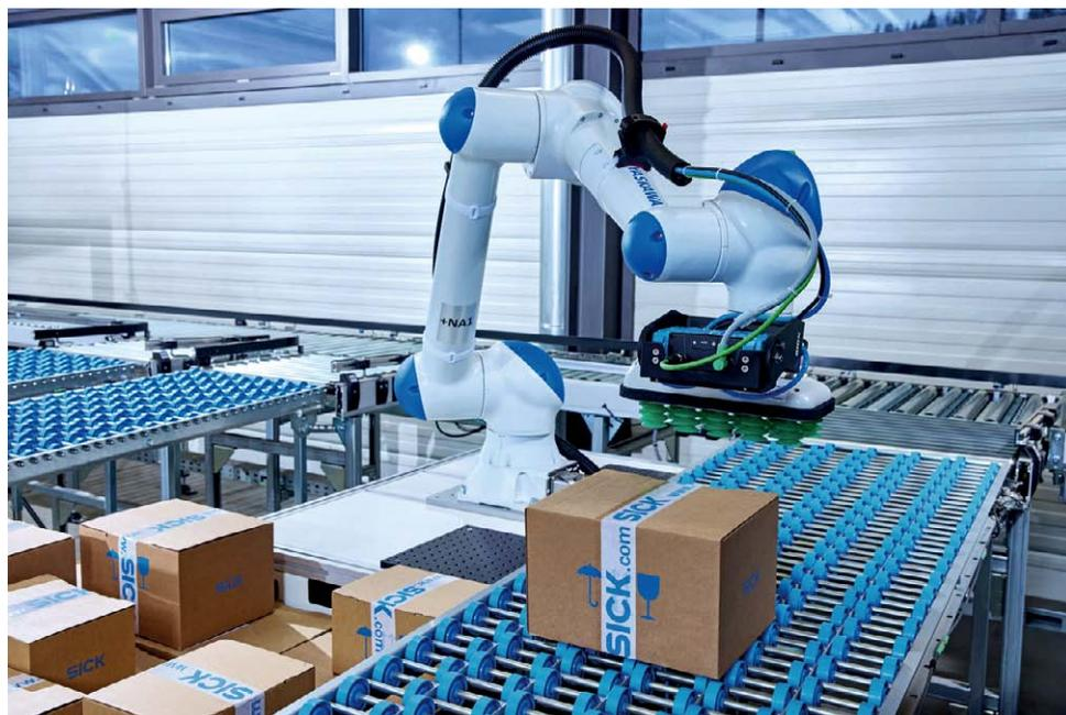
Das PALLOC-System wird ab Werk mit einem vorinstallierten neuronalen Netz ausgeliefert, das bereits mit großen Datenmengen von Boxen unterschiedlicher Größe, Farbe und Bedruckung sowie unterschiedlichen Designs trainiert wurde. (Bild: Sick)
