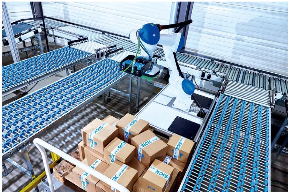
Eine 3D-Snapshot-Kamera mit einem vorinstallierten und vortrainierten neuronalen Netz ab Werk sowie ein neuer, Deep-Learning-basierter Lokalisierungsalgorithmus – das alles vereint sich im KI-gestützten, adaptiven Lokalisierungssystem PALLOC für die automatische Depalettierung mit Robotern. (Bild: Sick)
